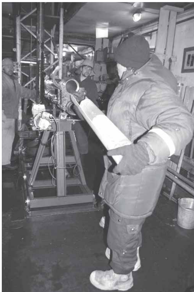
Извлечение керна льда озера Восток из кернаприемной трубы бурового снаряда. Станция Восток, январь 2007 г.
