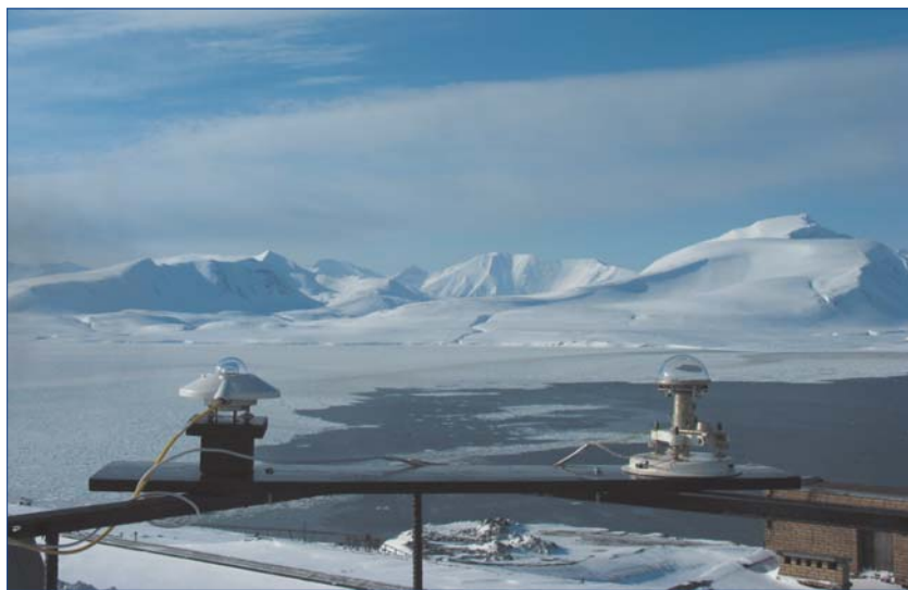
Стандартные российский (справа) и голландский (слева) актинометрические датчики, участвующие в интеркалибрационной процедуре (ЗГМО Баренцбург, апрель 2008 г., арх. Шпицберген). Фото Б.Иванова
