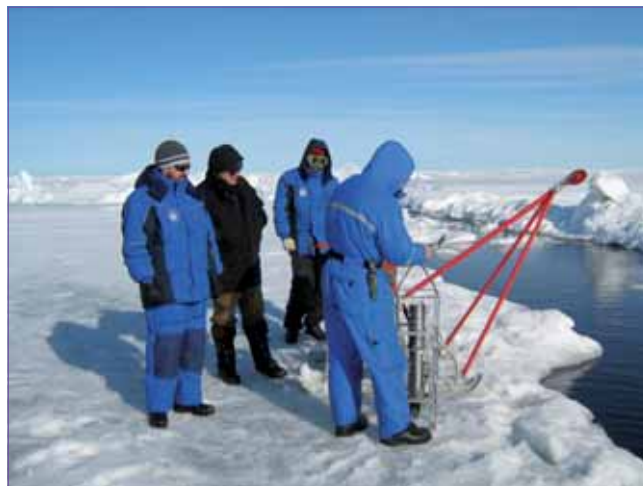
Выполнение выносной гидрологической станции с дрейфующего льда при помощи переносной лебедки и зонда «Sea Bird»
