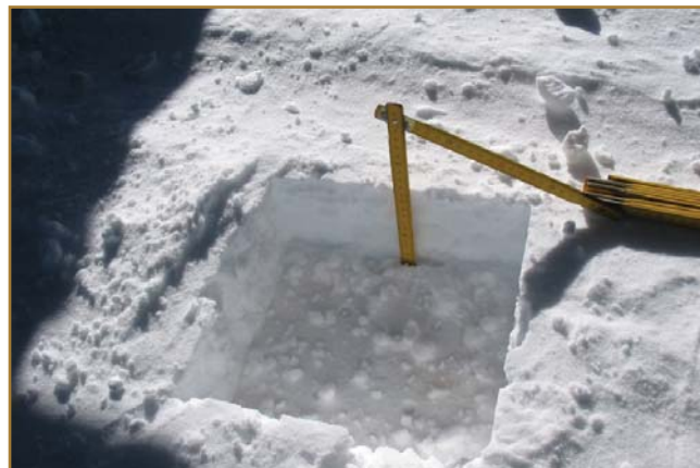
Результат штампового испытания на снежном покрове
