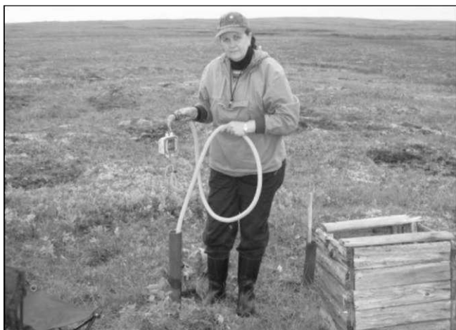
Оборудование скважины логгером для круглогодичного измерения температуры мерзлых пород
