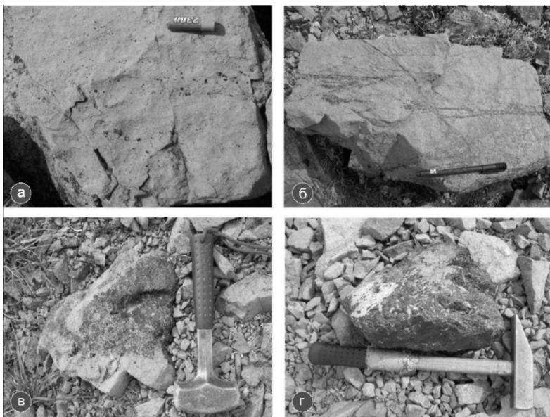
Типы хромитовой минерализации в дунитах, связанных постепенными переходами с шпинелевыми гарцбургитами: (а) рассеянно-вкрапленные, (б) струйчатые, (в) орбикулярные и (г) массивные выделения хромитов
