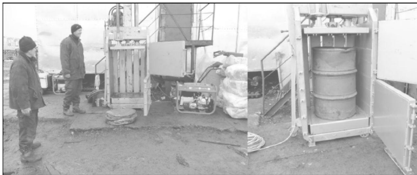
Работа прессы: слева - бочка современного производства сплюснута и лежит перед прессом, справа - видимых изменений с бочкой старой конструкции не произошло (вмятина сверху была раньше)
