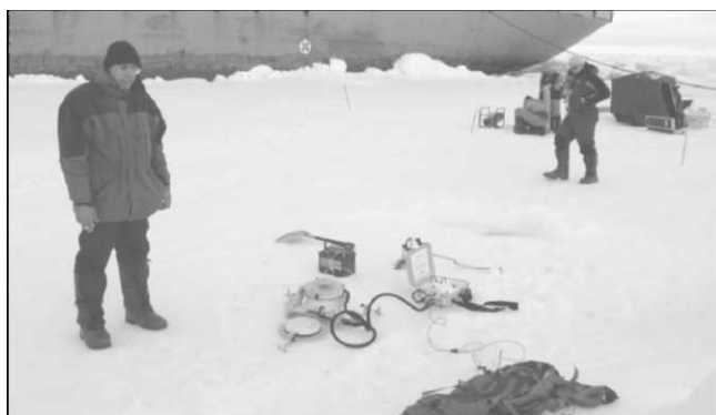
Измерение потоков CO 2 газоанализатором LI 8100
