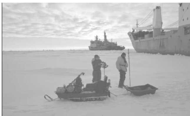
Измерение толщины льда в месте разгрузки судна
