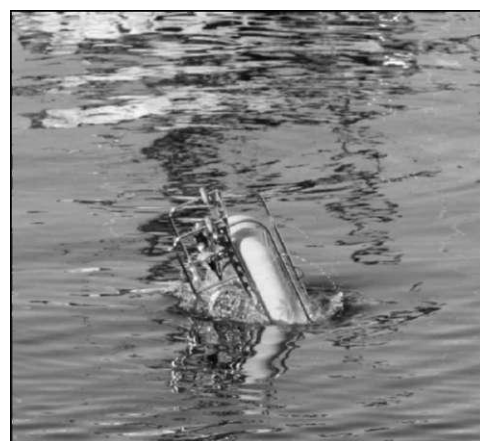
Подводный дистанционно управляемый аппарат Benthos Stingray во время работы
