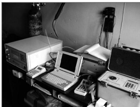
Рис.2. Автоматический анализатор ртути в воздухе «Tekran 2537A», установленный на станции мониторинга в районе п. Амдерма
