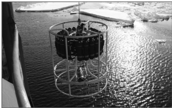
Рис. 4. Океанографические исследования с борта судна при помощи зондирующего комплекса «SeaBird 911». Фото Н.Н.Антипова
