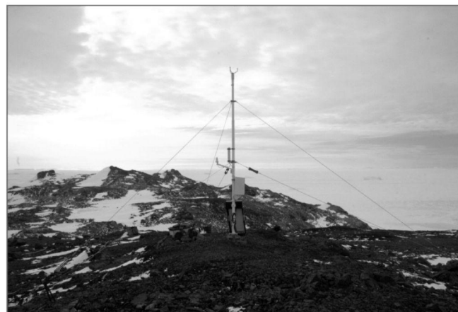
Рис. 3. Автоматическая метеорологическая станция на сезонной базе Русская. Фото В.Л.Мартьянова
