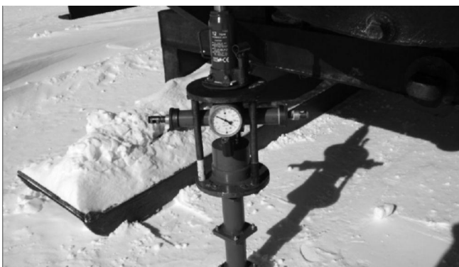
Рис. 2. Фрагмент ШТАМПОВОГО испытания
