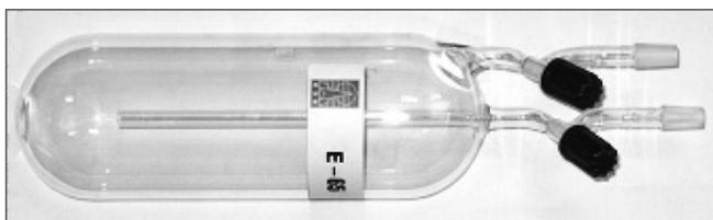
Рис. 5. Стеклонные фляги для хранения проб воздуха
