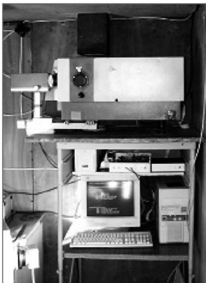
Рис. 4. Автоматизированный спектрофотометр для измерений общего содержания  $\text{NO}_2$  в атмосфере
