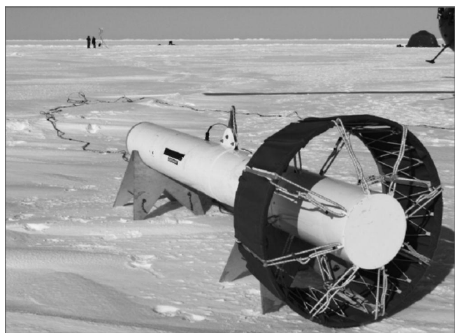
Рис. 2. Дистанционный измеритель толщины льда NEM-Bird
