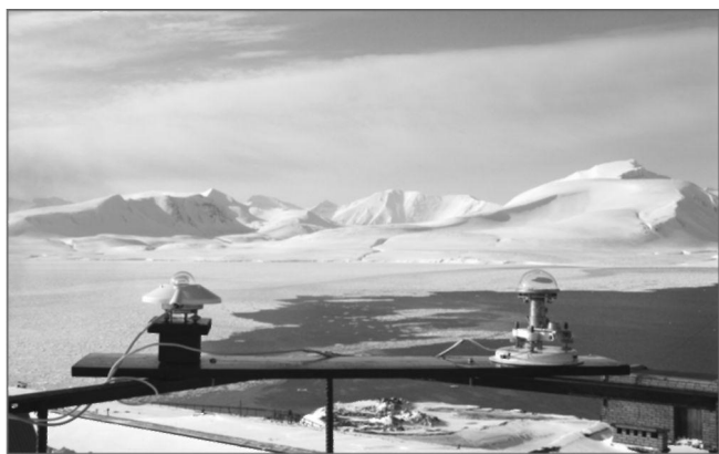
Рис. 1. Стандартные российский (справа) и голландский (слева) актинометрические датчики, участвующие в интеркалибрационной процедуре (ЗГМО Баренцбург, апрель 2008 г., арх. Шпицберген). Фото Б.В.Иванова
