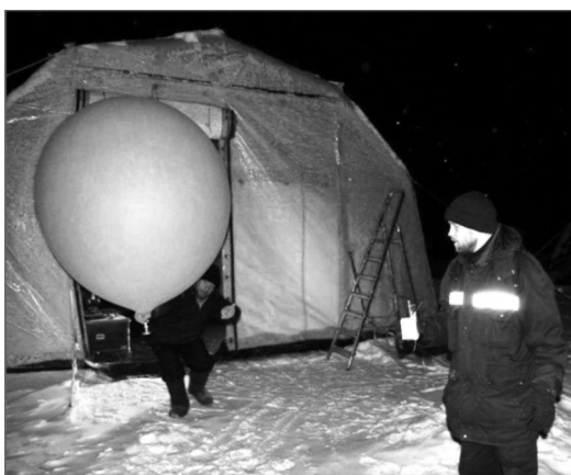
Рис. 1. Выпуск радиозонда на СП-35. Фото Е.Грассера (Институт им. А.Вернера, Потсдам)
