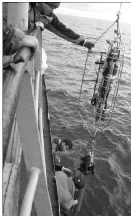
Вертикальное зондирование на океанографической станции
