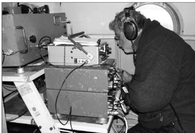
Рис. 1. Сотрудник ИГ РАН, профессор Ю.Я.Мачерет производит радиолокационное зондирование ледника с борта вертолета Ми-8. Фото А.Ф.Глазовского
