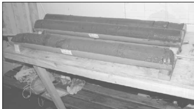
Образцы донного грунта, полученные при помощи грунтовой трубки
